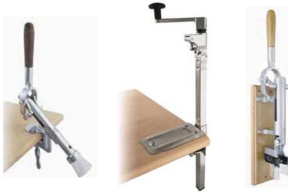
Conçu spécialement pour l'usage professionnel, peut ouvrir jusqu'à six boîtes par minute. La fixation de la base fixe l'ouvre-boîte à la partie inférieure de la table. Pour un usage avec des boîtes d'une hauteur allant jusqu'à 28 cm. La longueur de la barre est de 48 cm. La lame est réversible, trempée et carbonitrurée. Fabriqué en Espagne. Fondé en 1905, BOJ en est le concepteur et le fabricant.
